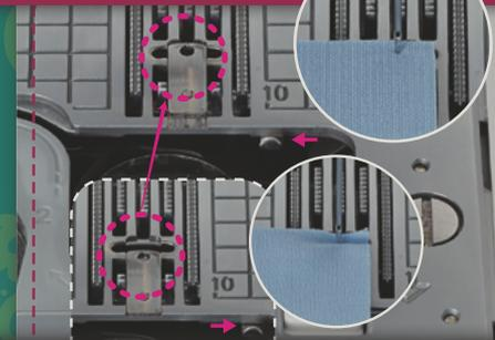
**Automatischer Nadeleinfädler:** Durch diese einfache Funktion ist das Einfädeln der Nadel ein Kinderspiel. Drücken Sie nur den Hebel herunter und der Nadelfaden fädelt sich von selbst ein. Spart Zeit, Mühe und schont die Nerven...
