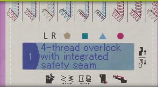
**LCD-Display der MO-2000:** Mit dem LCD-Display der MO-2000 wird Overlocken noch einfacher. Schnell und übersichtlich können Sie zwischen den Stichen und Einstellungen wechseln. Alle wichtigen Informationen sind mit einem Blick erkennbar.
