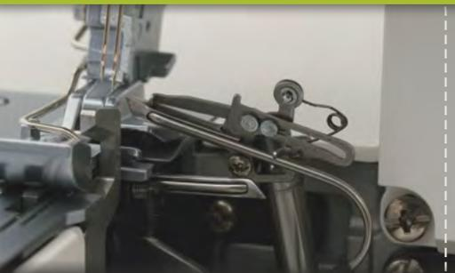
**Hilfsgreifer:** Für einfaches Nähen einer 2-fädigen Overlocknaht. Es reicht das Schieben nach links oder rechts und der Hilfsgreifer beginnt seine Arbeit, oder er beendet sie. Kein Suchen mehr nach dem Konverter, er ist da wo er hingehört, am Obergreifer befestigt.
