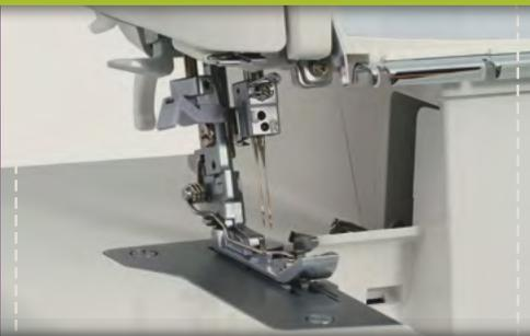
**Abstand Gehäuse - Stichplatte:** Mehr Freiheit beim Overlocken! Es ist Platz von 72,4 mm zwischen Gehäuse und Stichplatte. Da passt ordentlich was durch!
